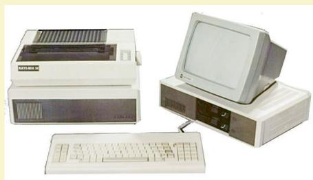
Während die früheren Computer aus zwei Einheiten bestanden, nämlich einer Prozessoreinheit und einer Speichereinheit, gelang es den Ingenieuren beim ES-1842 schließlich, den gesamten XT-Computer in ein Gehäuse zu integrieren. Dieser Computer ist recht selten, es wurden nicht sehr viele davon produziert. Es gibt Informationen, dass es etwa 10.000 Stück waren und noch weniger haben bis heute überlebt. Vielleicht liegt das daran, dass dieser Rechner gemäß der vor-
