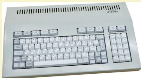
Der Rechner ist auf einem Z80-Prozessor aufgebaut, hat 128 KByte RAM und das Betriebssystem ist eine modifizierte Version von CP/M. Sie erlaubt es, modifizierte Programme für CP/M auszuführen. Das System enthält aber auch ein Programm, mit dem der Computer in den ursprünglichen ZX Spectrum-Modus umgeschaltet werden kann. Gleichzeitig ist der Arbeitsspeicher des Com-
