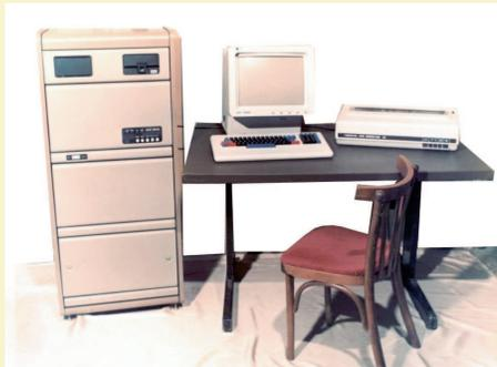
Der Computer läuft nicht unter MS-DOS, sondern unter dem Betriebssystem "BOS-1810", einem Intel RMX-86-Klon. Die Ma-
